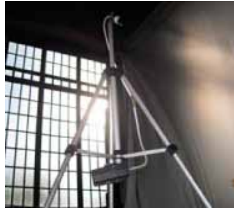
Figura 16. Muestreo estático ambiental
